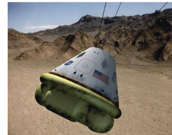
Airbags von rund 3 m Dicke genügen auf der Erde nach einem Fallschirmabstieg für weiches Aufsetzen.
